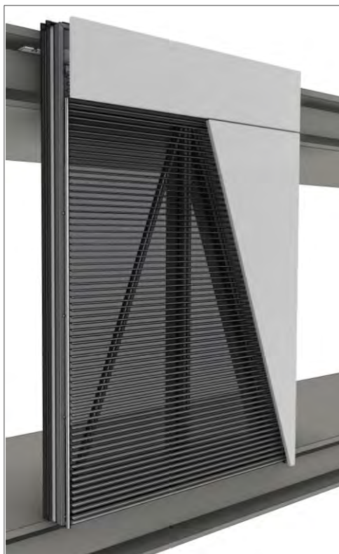
3D Konzept, Fassadenelement
