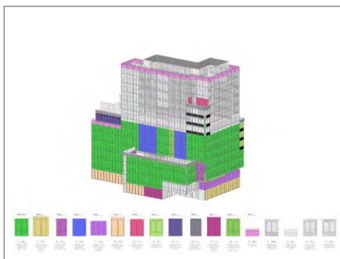
3D-Fassadentypenübersicht, selektierter Bereich
